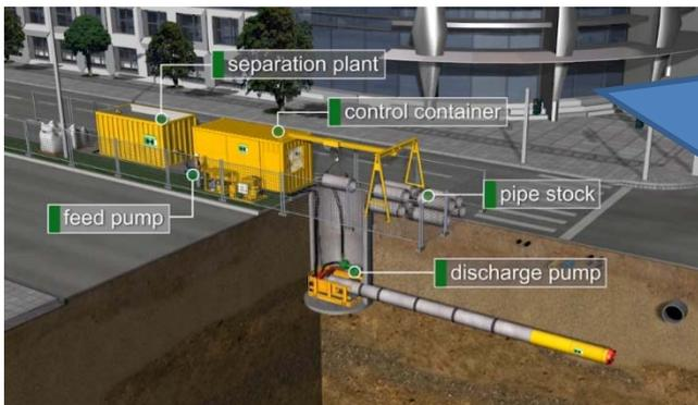
La tubazione viene costruita per conci, e viene fatta avanzare per spinta nel terreno preceduta da uno scudo di acciaio dotato di testa fresante, a partire da un pozzo di partenza fino a quello di arrivo ed estrazione della fresa.
