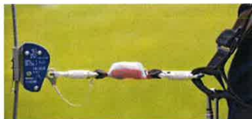
1 Cursore per cavo con assorbitore di energia incorporato
