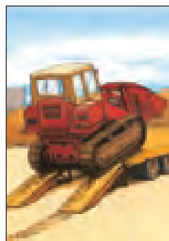
fase di caricamento sull' autocarro
