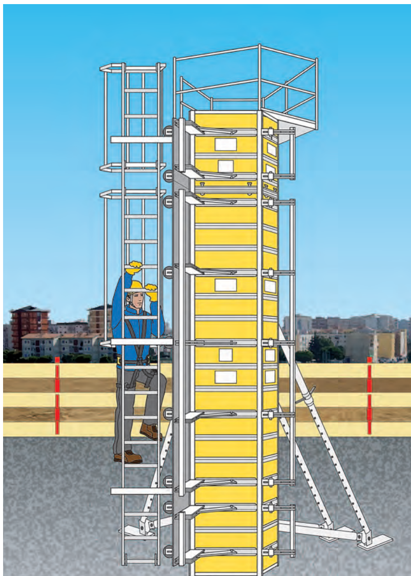
Figura 3 - Cassaforma verticale prefabbricata a telaio per pilastri
