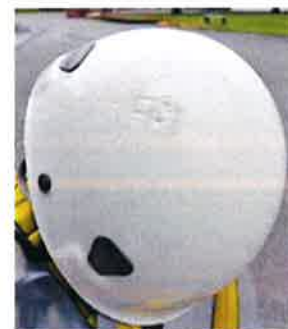
3 Va sostituito anche questo casco con un difetto visibile.
