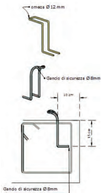
Figura 5.2.2-10 Rete di tipo V - Particolare omega e gancio di sicurezza
