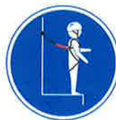
2 Un sistema di ritenuta: tiene lontana la persona dalle zone con pericolo di caduta. Se utilizzato nel modo giusto, non ci sono pericoli di caduta dall'alto.
