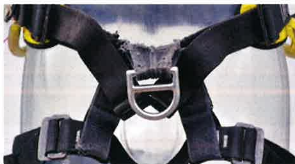
2 Bisogna sostituire questa cintura di posizionamento molto danneggiata.
