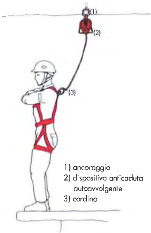
Fig. 10 - Sistema di arresto caduta costituito da imbracatura, fune di trattenuta e dispositivo anticaduta retrattile.
