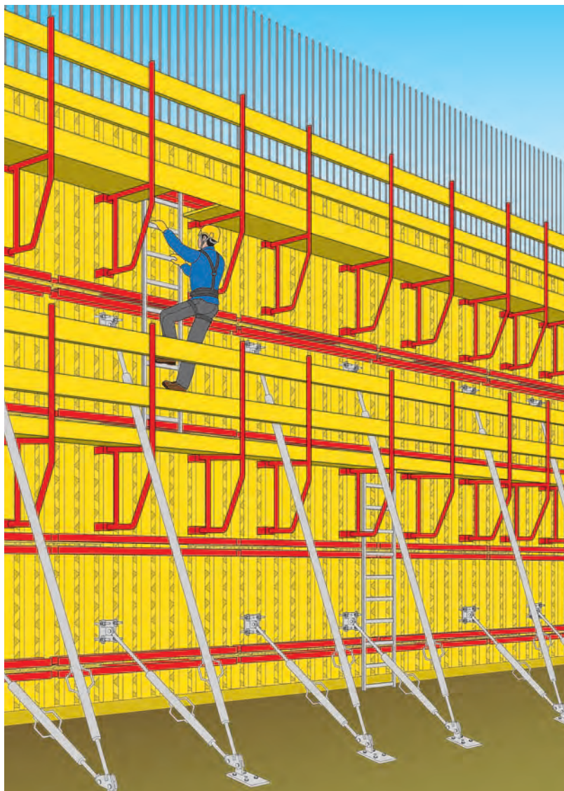
Figura 2 - Cassaforma verticale prefabbricata componibile
