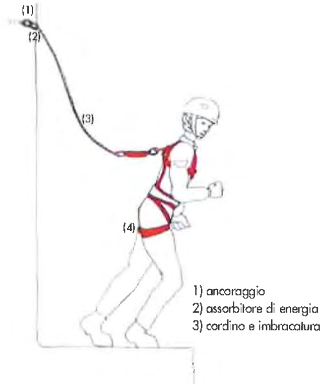
Fig. 11 - Sistema di arresto caduta costituito da imbracatura, cordino e assorbitore di energia
