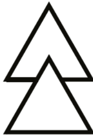
Figura 4.1: Simbolo del doppio triangolo per indicare l'idoneità del DPI come misura contro lo shock elettrico
